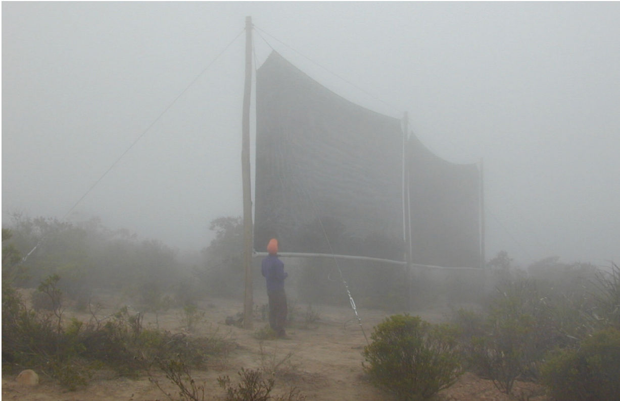
Figura 3. Los colectores de niebla a gran escala generan agua cuando la visibilidad es menos de unos 300 metros (Chile). Fotografía: R. Schemenauer.
