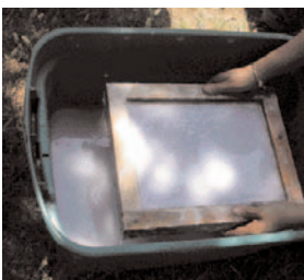
Paso 6 El contramarco se coloca sobre el anverso del bastidor para que se introduzca en la tina, haciendo que coincidan los extremos.
