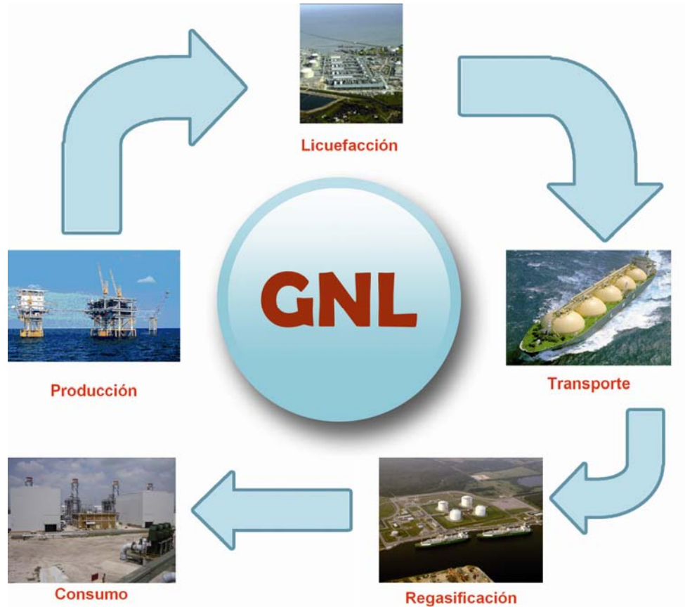
Fig. 2: Cadena de producción de GNL
