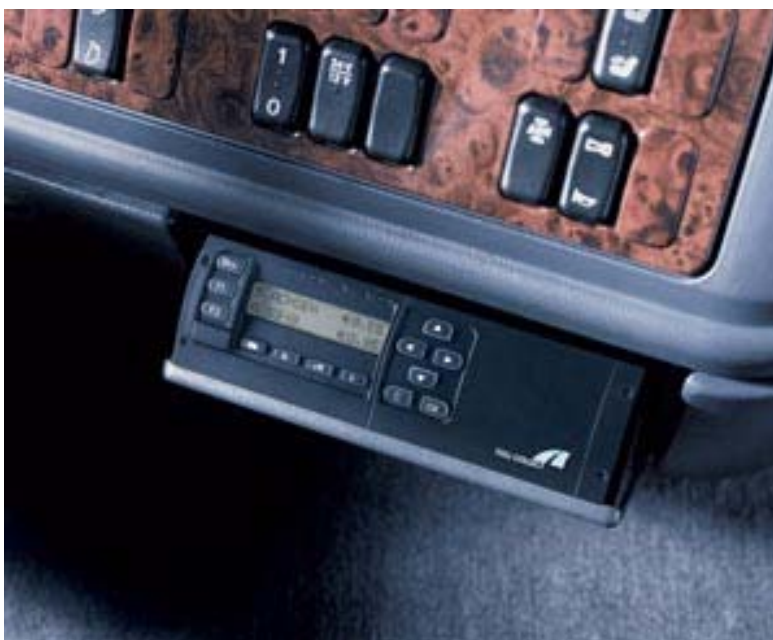
Figura 3. Equipo a bordo de los camiones en Alemania para medir vía satélite el kilometraje recorrido, calcular el peaje y procesar la información.
