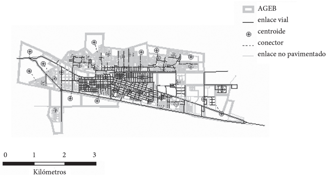
FIGURA B2. MODELO DE RED VIAL PARA RÍO BRAVO
