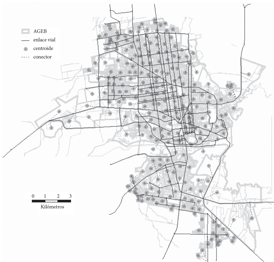
FIGURA 6. EJEMPLO DE RED VIAL SIMPLIFICADA DE MODELACIÓN PARA HERMOSILLO
