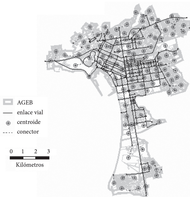
FIGURA B3. MODELO DE RED VIAL PARA ENSENADA
