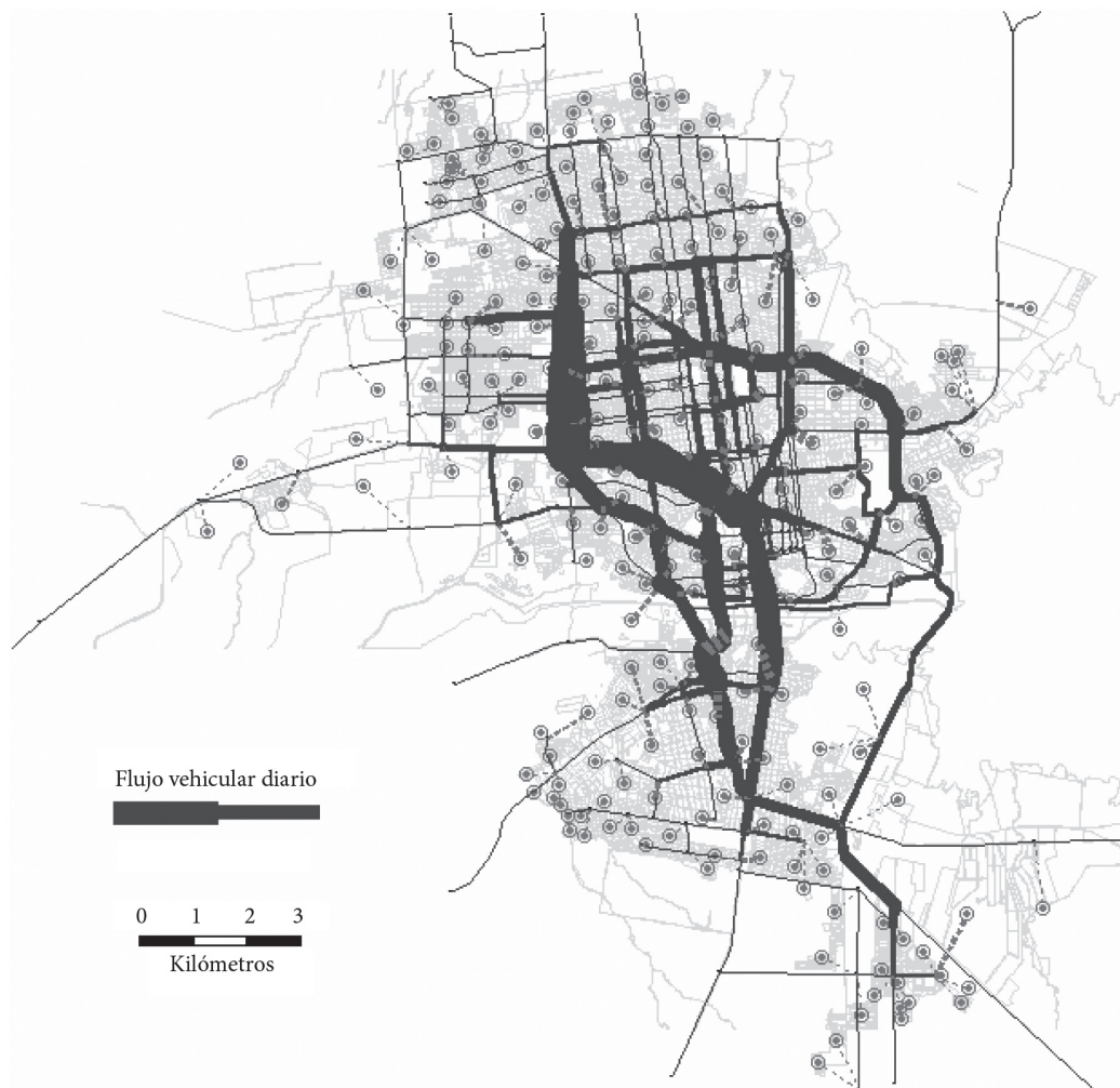
FIGURA 7. EJEMPLO DE RED VIAL CARGADA PARA HERMOSILLO
