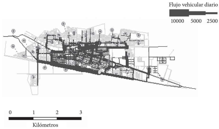
FIGURA D2. RED VIAL CARGADA DE RÍO BRAVO
